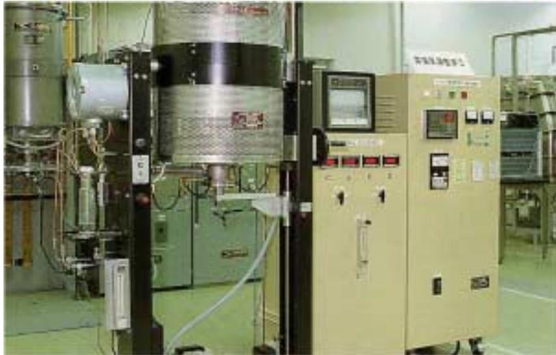
参考図7 ペレット焼結炉
