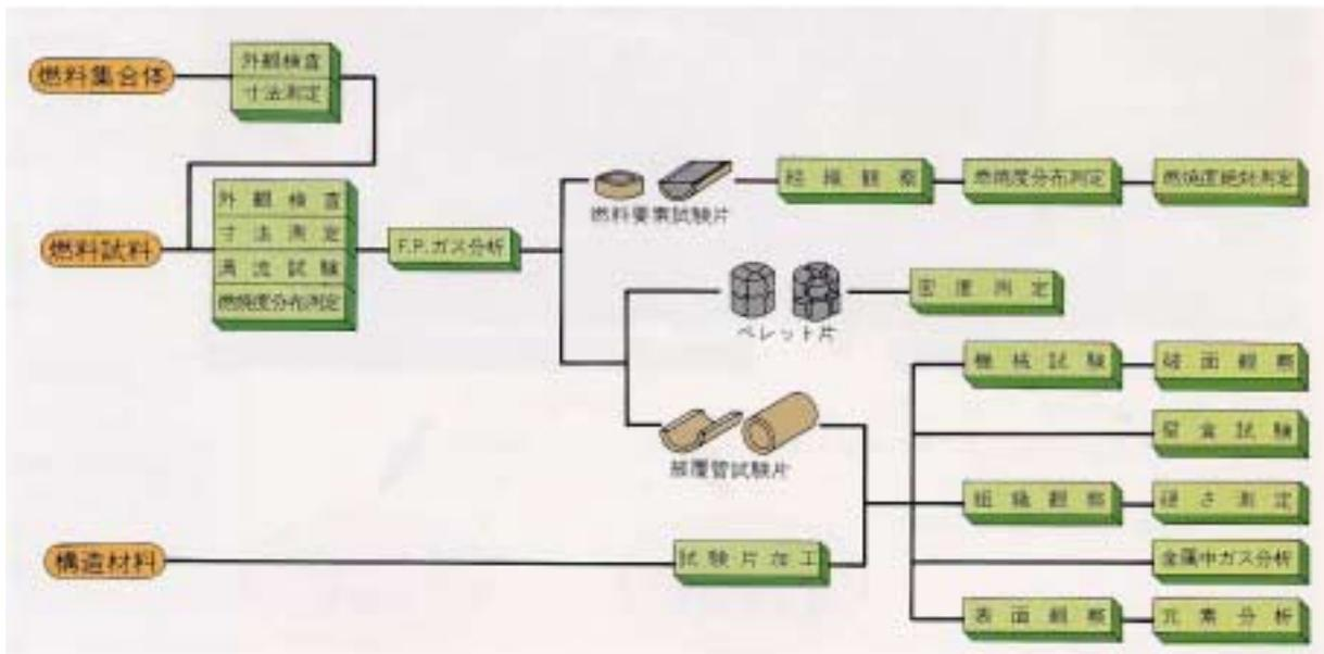
参考図5 照射後試験の標準的な作業フロー
