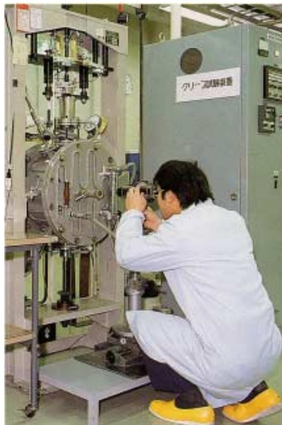
参考図8  $\text{UO}_2$ ペレットクリープ測定装置
