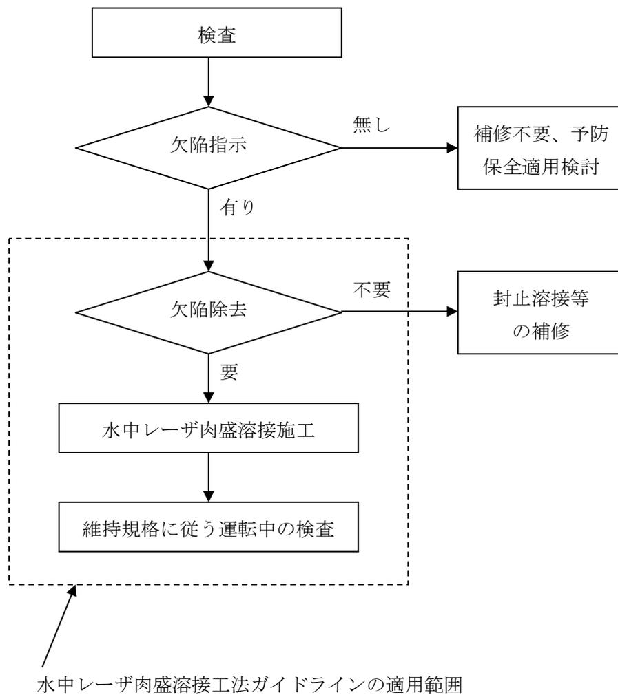
図2 水中レーザー肉盛溶接工法の適用フロー
