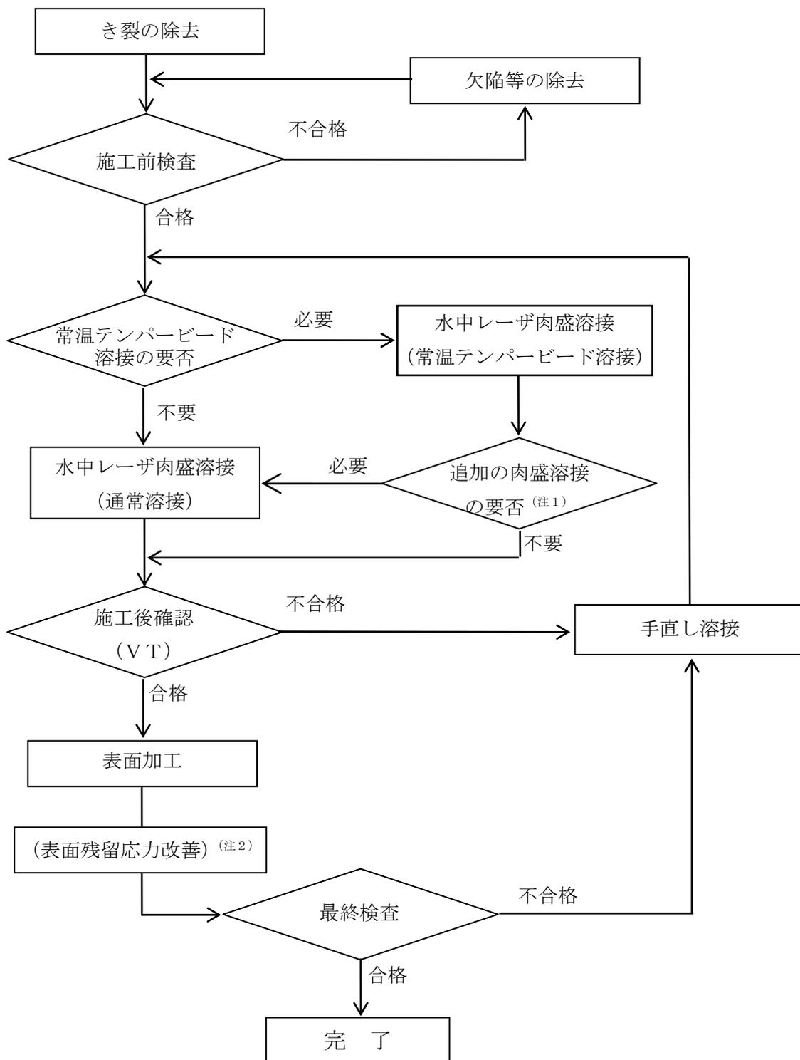
(注1) 常温テンパービード溶接のみで埋め戻しが完了しない場合は、通常溶接を追加で実施する。
