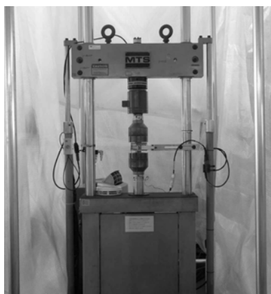
図 4.3.4-2 繰返し予ひずみ付与及び予ひずみ付与後の疲労試験に用いた試験機
