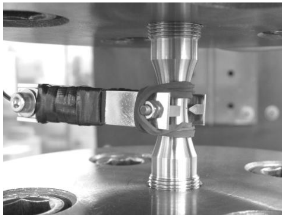
図 2 試験に用いた油圧サーボ疲労試験機 (容量 100kN)
